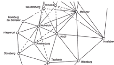
Netzskizze des mittleren Teils der kurhessischen Haupttriangulation
