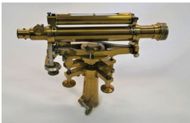
Abb. 18 und 19: Nivellier des Herstellers C. Staudinger aus Gießen von ca. 1865 mit der Geräte-Nummer 1
