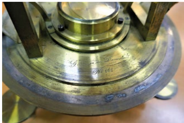
Abb. 23 und 24: Siener-Theodolit Nr. 161 der JLU Gießen – rechts die Firmengravur
