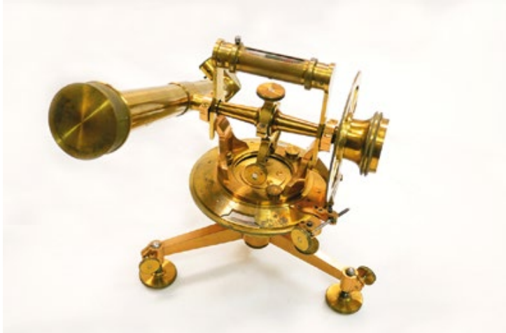
Abb. 37 und 38: Der Breithaupt-Ballon-Theodolit Nr. 331 aus dem Jahr 1851
