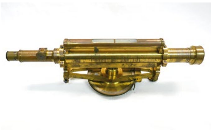
Abb. 35 und 36: Siener-Nivellier mit Horizontal-Teilkreis – rechts die Firmengravur
