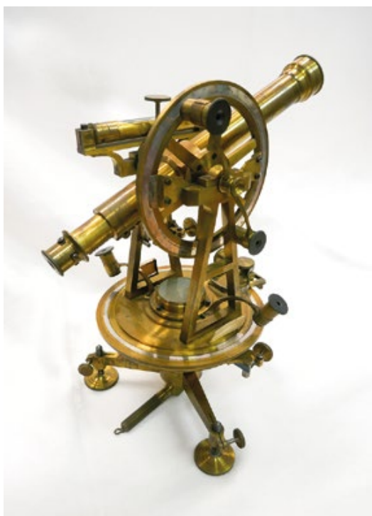
Abb. 27 und 28: Schäffer-Theodolit Nr. 35 von ca. 1870 – rechts die Firmengravur
